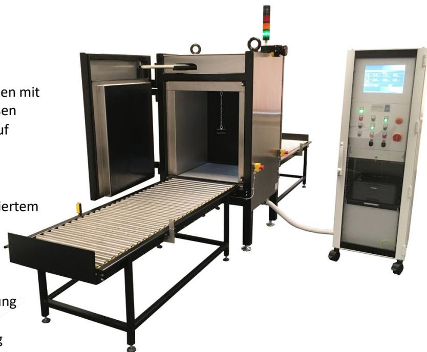
Der HWM-400S erlaubt eine schnelle und zuverlässige Erkennung von Gammastrahlung. Auf Basis der neuesten Messelektronik, den eingebauten Wartungsmodulen sowie der ausgefeilten Systemsteuerung kann das System kontinuierlich optimiert werden und liefert konstant hohe Performance bei jeder Messaufgabe.
