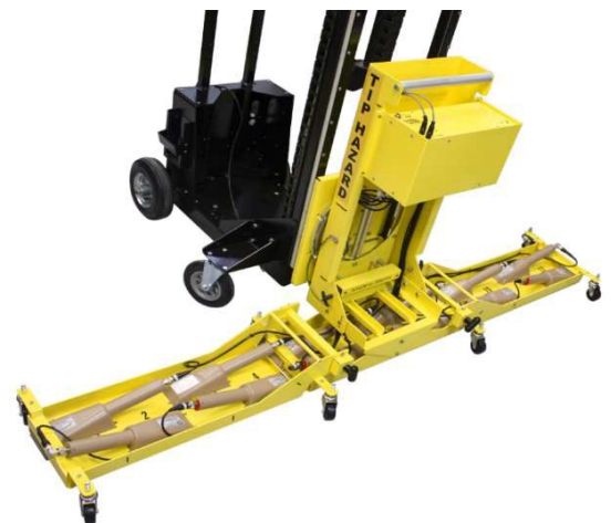
Unten ist das Modell 240S mit Szintillations-Detektoren in der Bodenmessposition dargestellt.
