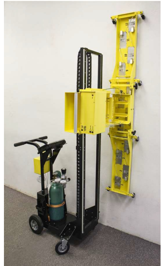
Das obere Foto zeigt die Version mit Gasproportional-Detektoren des Model 240 in der Wandmessposition (ohne Verschlauchung).
